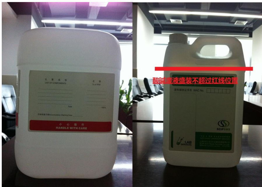
左图为 25L 废液桶：主要用于盛装有机废液和无机废液，桶身标签可标注废液具体成分。 右图为 5L 废液桶：主要用于盛装酸、碱废液，盛装时废液体积不超过图中红线标示处，桶身可标注废液具体成分。
